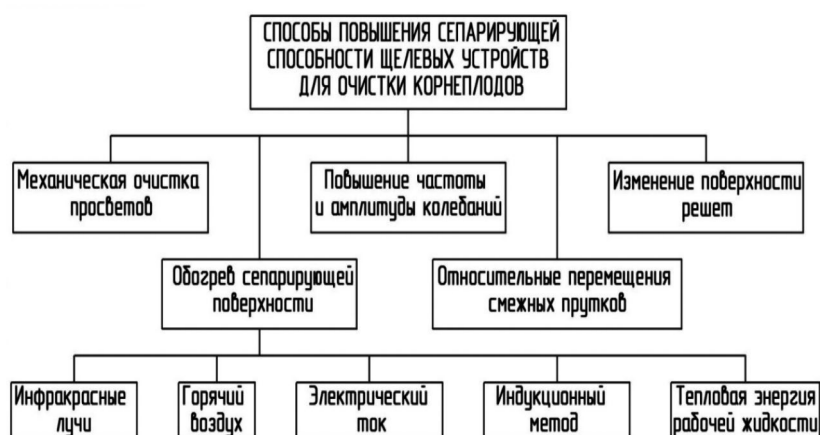
Рис. 1. Классификация способов повышения сепарирующей способности щелевых устройств для очистки корнеплодов.
