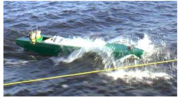
Рис. 7. Разворот модели с попутного курса на встречный
